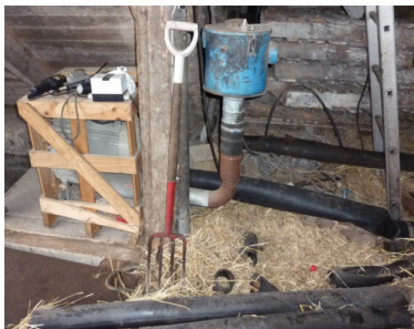
Kornblæser (i trækasse) tilsluttet gl. vandingslanger med huller i, som leder luften ind under komposteringsmåtten.
